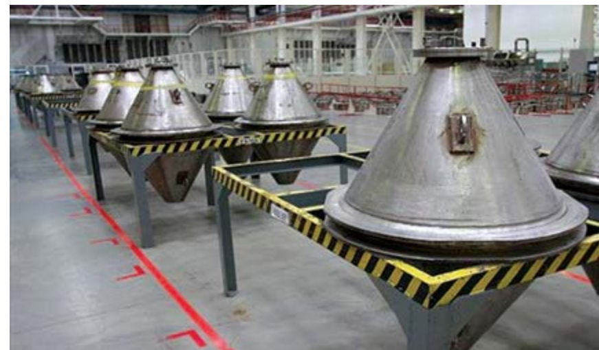
Рис.2 - Биконусы хранения порошка диоксида урана
