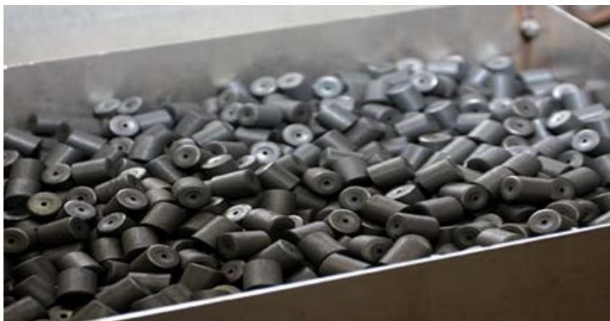
Рис.3 - Таблетки диоксида урана после отжига в водородной печи
